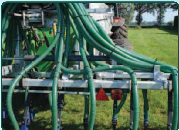
Detail van het hydraulisch opplooi- mechanisme
